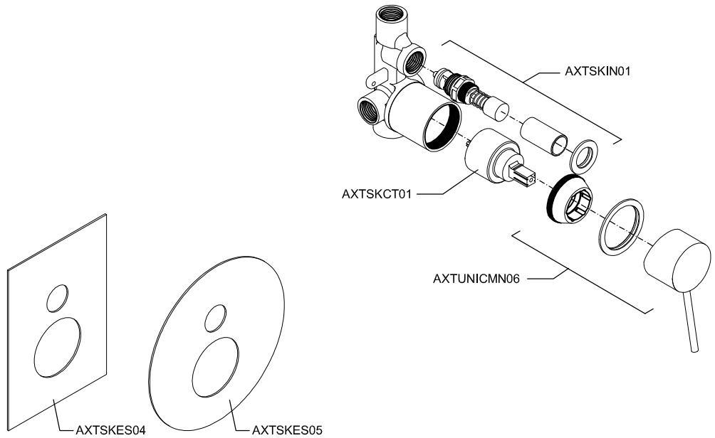
Termostática 4 vias - Termostática 4 vías - Thermostatic 4 ways - Thermostatique 4 voies
