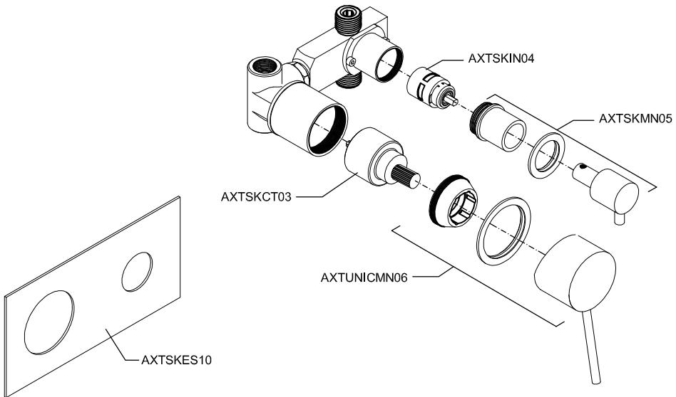
Termostática 4 vias - Termostática 4 vías - Thermostatic 4 ways - Thermostatique 4 voies
