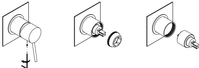
Cartucho Termostático - Cartucho Termostático - Thermostatic Cartridge - Cartouche Thermostatique
